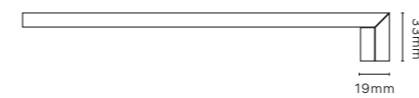
step extra thick corner . nez de marche forte épaisseur angle ecke massive stufenplatte . degrau espessurado canto
